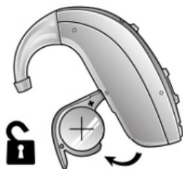
*Aprire completamente il vano batteria per sostituire la batteria.*
