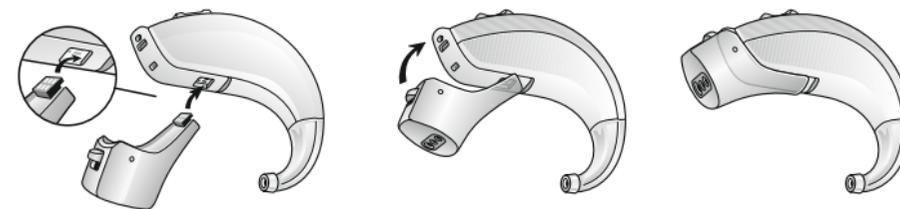
Connexion du sabot sur un modèle de la série 86.
