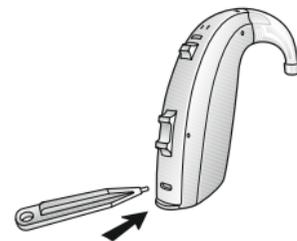
Insérez l'outil directement dans l'ouverture située au dos de l'aide auditive, en dessous de la commande de volume.
