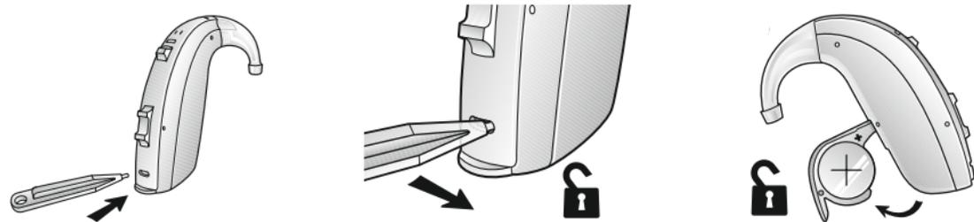
Insérez l'outil directement dans l'ouverture située au dos de l'aide auditive, en dessous de la commande de volume.
