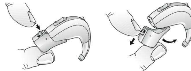
Déconnexion d'un sabot sur un modèle de la série 86.
