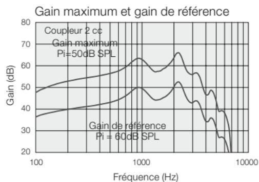
Mesures effectuées conformément aux recommandations des normes CEI 60118-0 Edition 3.0 2015-06, CEI 60118-7 et ANSI S3.22-2009 à 1,3V.
