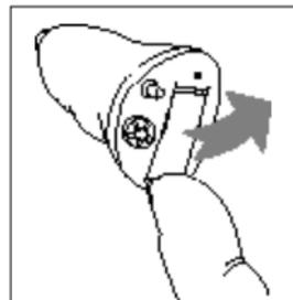
4. Inserire la nuova batteria con il polo positivo nella posizione corretta. Inserire sempre la batteria nello sportellino aperto, mai direttamente nell'apparecchio.
