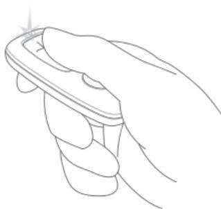
2. Appuyez sur la partie inférieure de la commande de volume (-) pour réduire le volume.
